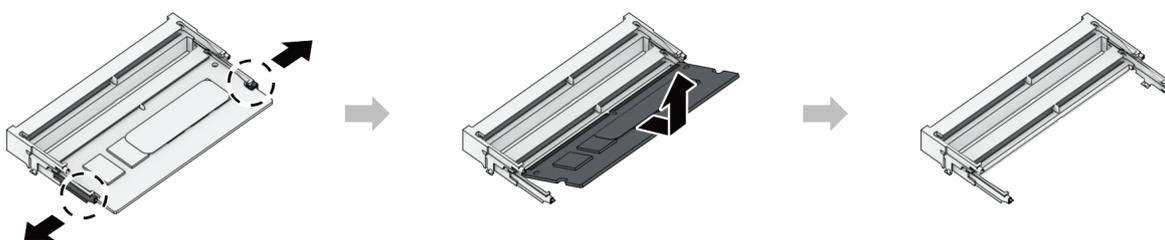
6. Setzen Sie die Laufwerkträger wieder in die Einschübe ein.
