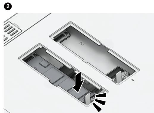
5. Wiederholen Sie diese Schritte bei Bedarf, um ein weiteres SSD-Modul im zweiten Steckplatz einzusetzen.
