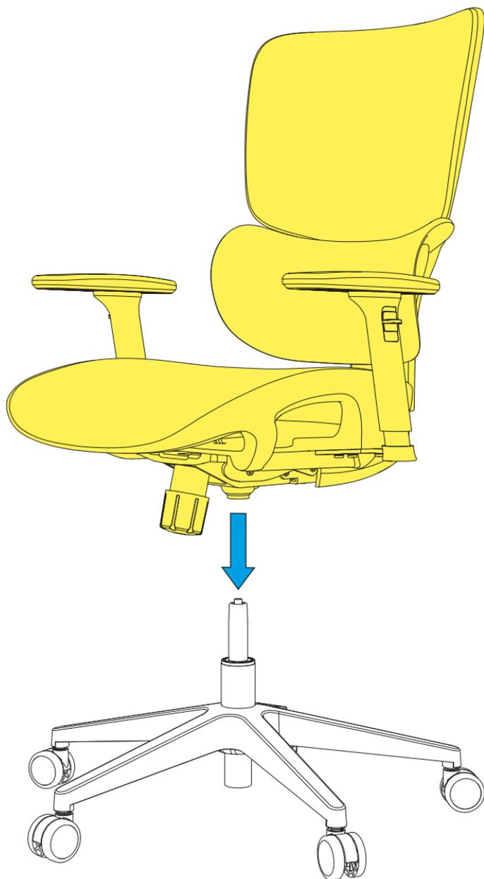
**Achtung! Um Sach- und Personenschäden zu vermeiden, vergewissern Sie sich, dass Stuhlmechanik und Gasdruckfeder korrekt montiert sind!**
