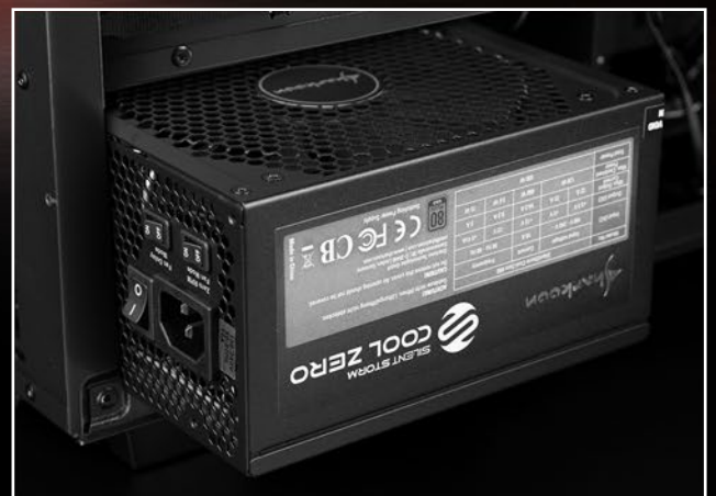
Einbau mit gedrehtem Netzteil
