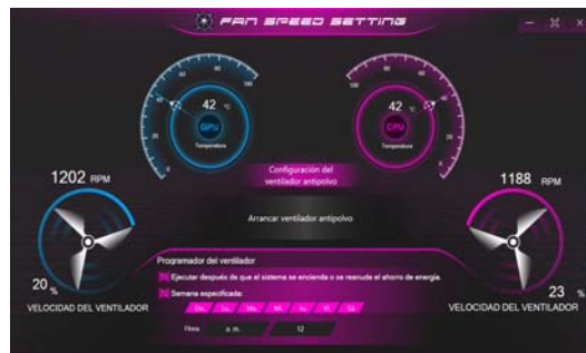
Figura 9 - Control de velocidad de FAN/ Configuración del ventilador antipolvo
